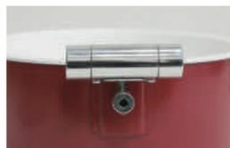
陶器インサートをセットして蓋がしまりにくくなる事もございます。その時は本体後部を六角ネジで調整して下さい。
